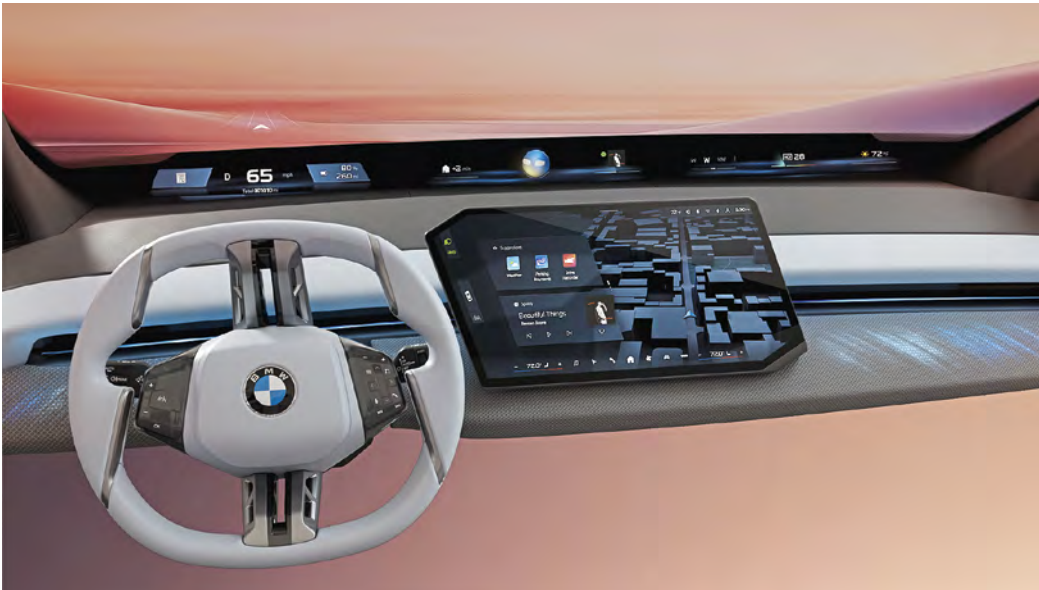
Das BMW Panoramic iDrive: Das Display hinter dem Lenkrad verschwindet. Dafür erhalten Fahrer und auch Beifahrer Informationen in Augenhöhe.
