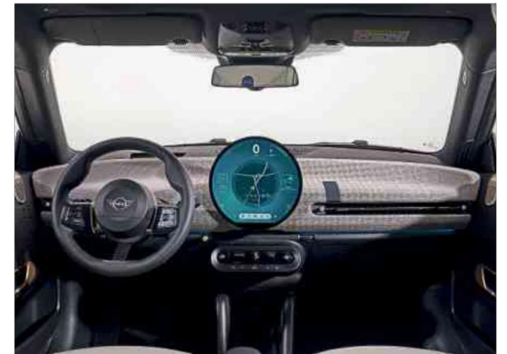
Das runde OLED-Display ist der Dreh- und Angelpunkt des neuen Mini-Cockpits. Foto: Hersteller
