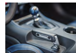
Die Handbremse ist elektronisch und erzeugt keinerlei Widerstand.
