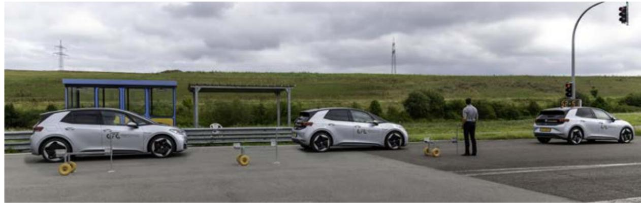
↑ Comme on le constate très bien sur cette photo, la distance d'arrêt (temps de réaction et freinage) augmente considérablement si l'on roule à 50 km/h (véhicule arrêté à droite de la photo) au lieu de 30 km/h (véhicule du milieu).
